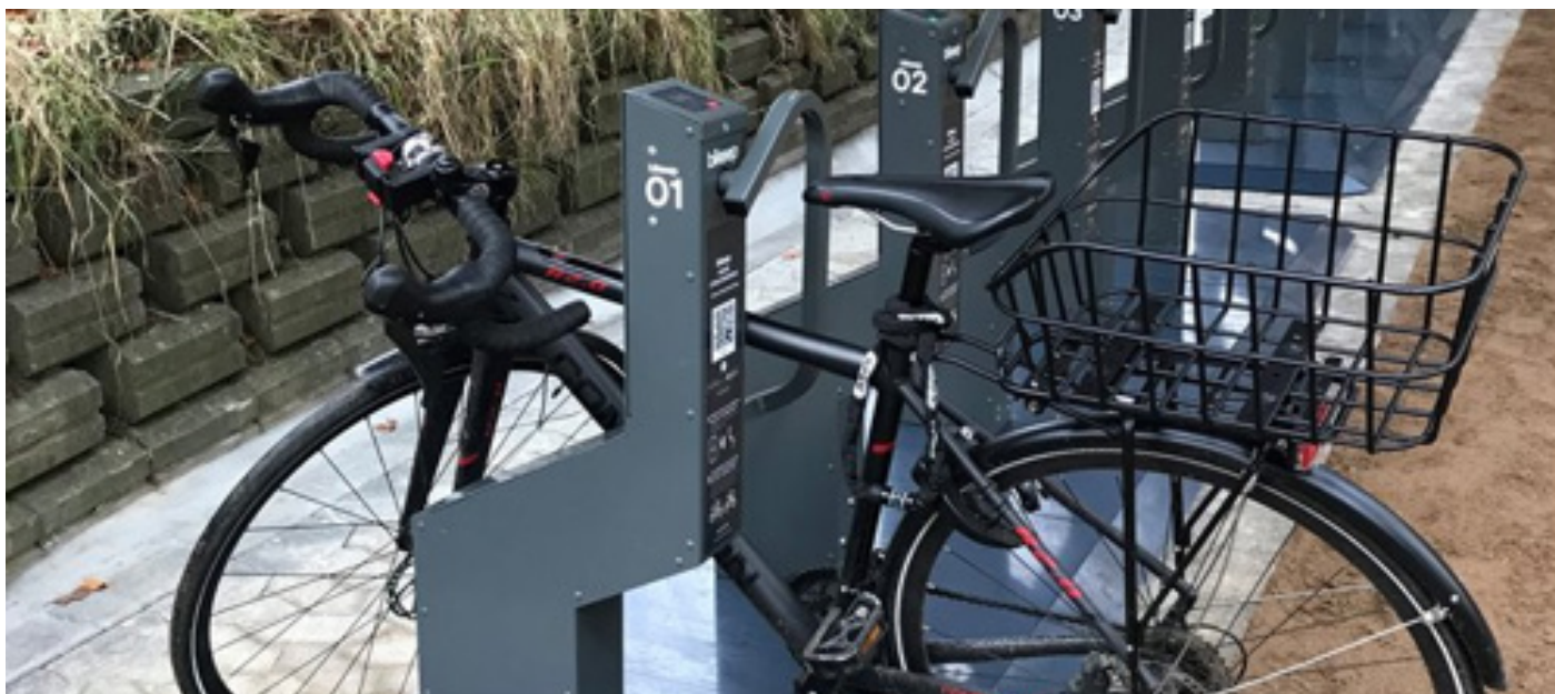
Automatiske og tyverisikrede stativer, der kan anvendes med chipkort er en god løsning til både kort- og langtidsparkering ved kollektive trafikknudepunkter.
