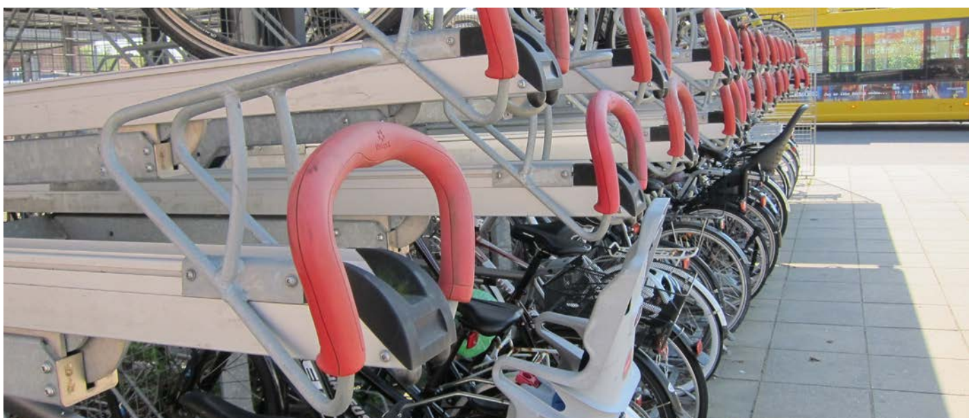
2-etagers stativer kan til nøds anvendes, hvor arealerne er knappe. Men husk at anvende en model med hydraulisk eller mekanisk hjælpehejs i overetagen.
